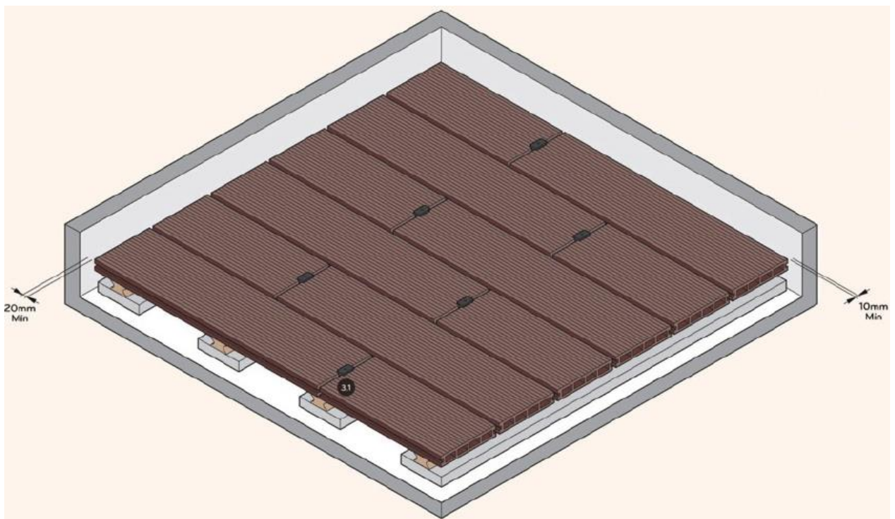
Obr. 7 – pokládka WPC desek s dodržáním dilatačních mezer
